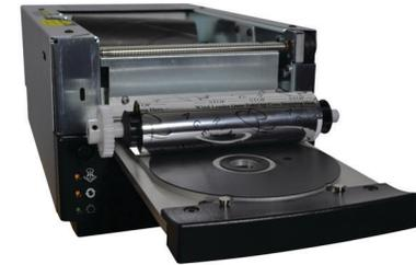
**¡Importante!** No enrolle más allá de la marca del comienzo que indica **STOP - Wind Leader Onto Take-up Core Stopping Here (Deténgase: enrolle el comienzo de la cinta en el centro de recogida hasta aquí)** para las cintas de un solo color. Si utiliza una cinta CMY, enrolle hasta el extremo del comienzo amarillo.
