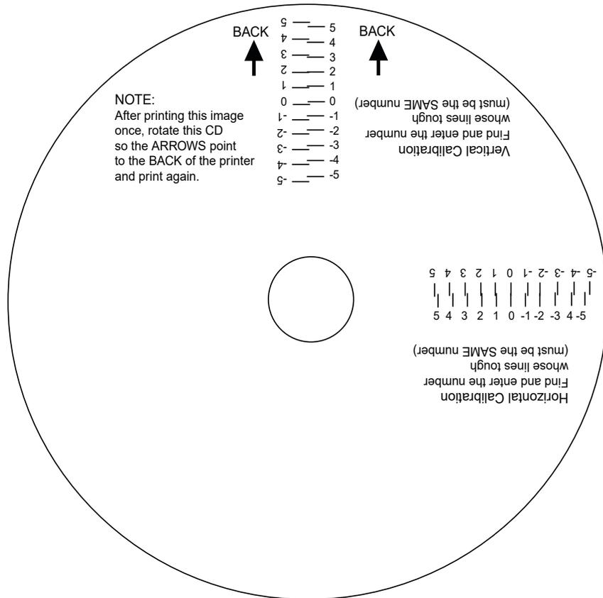
5. 沿着打印光盘的纵轴，找到其线触及的数字。例如，在上图中，将数字 2 输入 **校准** 窗口的 **垂直** 框中，为 **水平** 轴输入 0。
