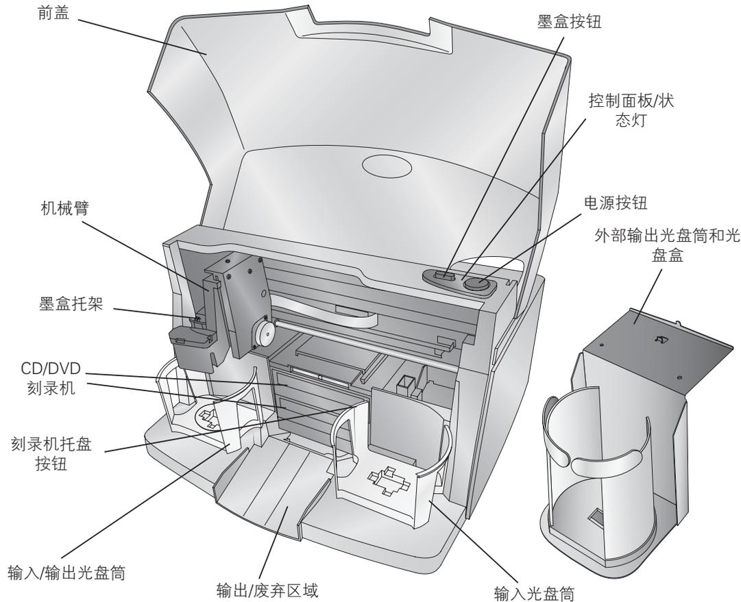
机械臂将光盘从输入光盘筒移到 CD/DVD 刻录机、打印机，最后移到输出光盘筒。
