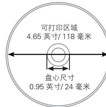
**注：**Rimage 介质的打印区域的外径为 4.65 英寸 / 118 毫米而内径为 0.95 英寸 / 24 毫米。在大多数标签上，建议使用 118 毫米和 24 毫米的打印设置。请参阅图示。
