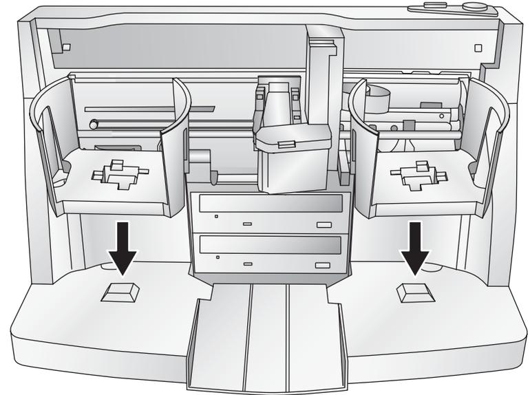
3. 最多将 50 张空白光盘加载到**输入光盘筒**（此光盘筒位于系统右侧）中。
