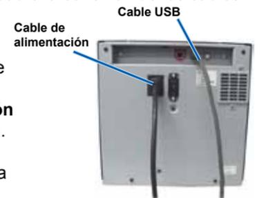
📌 **Nota:** la impresora Everest se enciende cuando se conecta el cable de alimentación de la impresora a la toma de corriente. Encenderá la impresora durante la instalación del controlador en el paso 6.
