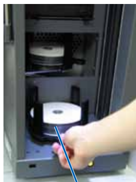
Raccoglitore di ingresso 1
