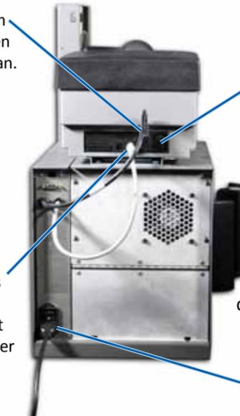
**Bemerkung:** Stellen Sie sicher, dass der Netzschalter am Prism III Drucker ist in der **On** Position. Die Energie zum Prism III Drucker wird durch den AutoPrinter kontrolliert.
