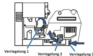
g. Entfernen Sie die **Kunststoff-Transportsicherungen** im Inneren des Druckers.
